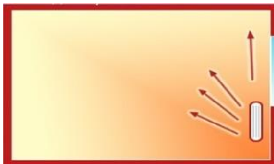
Рис. 2. Распределение тепловых потоков в помещении от радиатора
